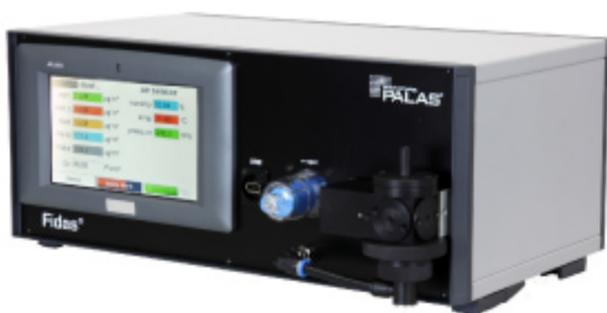
Le FIDAS est un spectromètre optique de très haute résolution permettant de classifier les aérosols atmosphériques en 64 classes de taille. Il mesure de manière simultanée et continue les poussières PM-10, PM-2,5, PM-1 et dispose d'une gamme de mesure allant de 0,18 à 18µm. Le FIDAS a été testé par le TÜV et certifié pour le suivi des fractions massiques PM-10 et PM-2,5 dans l'air ambiant (certification en pièce jointe).
